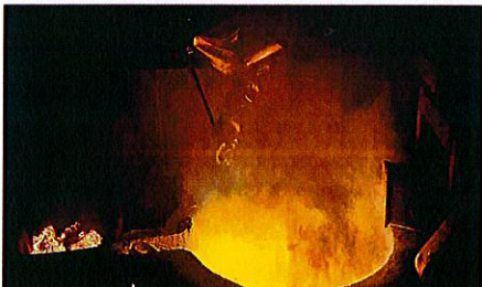
■ Le four est chargé de quatre tonnes de déchets métalliques au préalable découpés et triés. Une coulée dure environ deux heures. Photos MIKAEL ANISSET
