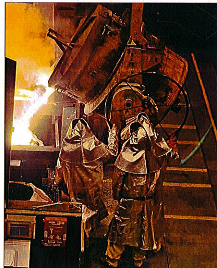
■ Les 4 tonnes de métal en fusion sont réparties dans 4 lingotières avant de refroidir durant près de 24 h. Même scénario pour chaque coulée.
